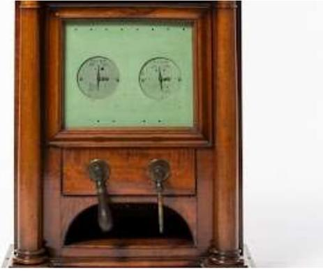
El telégrafo permitía una comunicación casi instantánea entre dos puntos alejados entre sí. En una ciudad podían enterarse de inmediato de un crimen cometido en otra, o de cuáles eran los precios de las materias primas. Los cables submarinos mundializaron las comunicaciones. Telégrafo primitivo utilizado en Bélgica Londres (Gran Bretaña), hacia 1844 Cooke and Wheatstone © Unión Europea 2016 / Casa de la Historia Europea, Bruselas (Bélgica).
